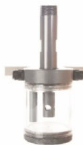
密闭式流通池安装
