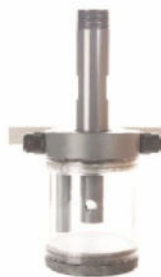
密闭式流通池安装
